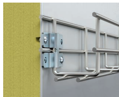
Wand- und Bodenbefestiger WB GR Befestigungsbauteil zur direkten Montage von Gitterrinnen an Wand und Boden. Niet- und schraubbar. Geeignet für die Drahtstärke 3,9 mm.
