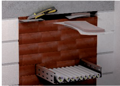
Vákuum blokk a rések egyszerű lezárásához.
