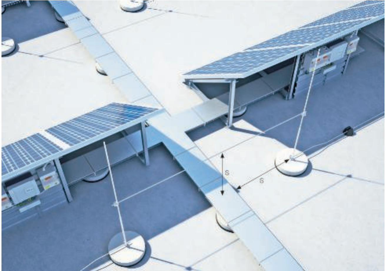
Biztonsági távolság (s) a villámvédelmi rendszer és a kábeltartó rendszer között
