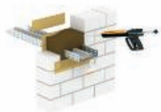
Tűzgátló tömítés tűzálló épületszerkezetben
